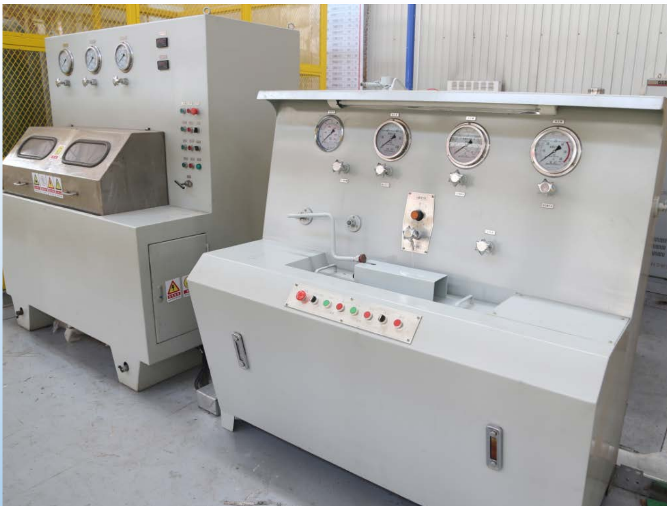
Испытательный стенд проверки клапанов 2000 л/мин
