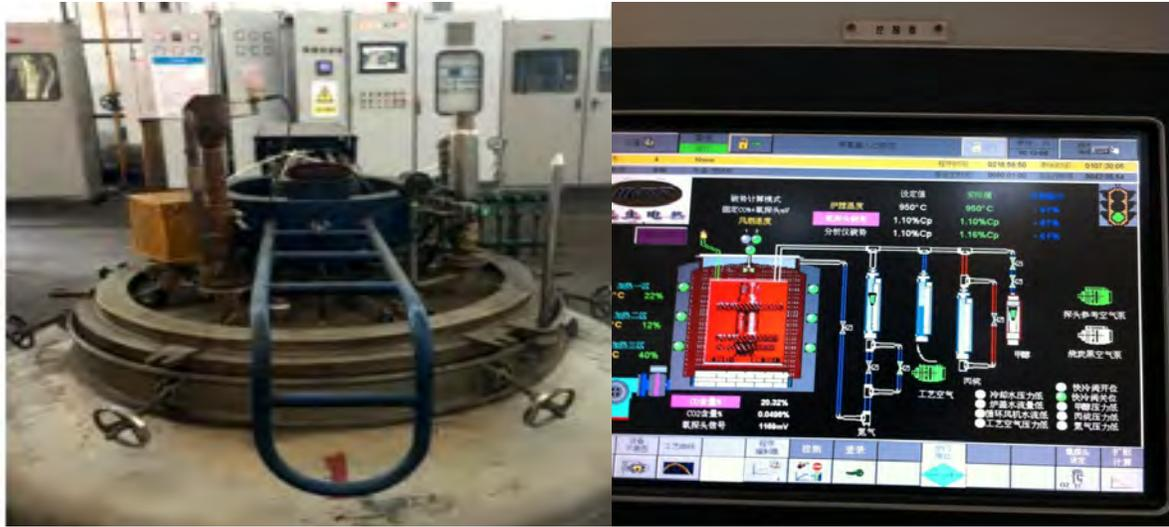
Ⓢ Компьютерное управление процесса цементации зубчатых колес
