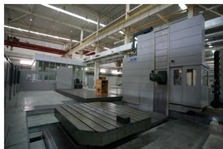
Немецкий сверлильно-фрезерный обрабатывающий центр с ЧПУ SHW
