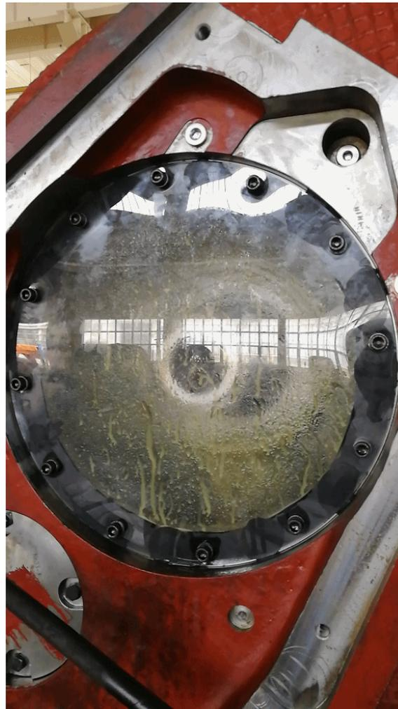
В тесте на разбрызгивание при угле подъема 53° объем заправленного масла в корпусе качалки составлял 75 л, смазка солнечного колеса показала хороший результат.
