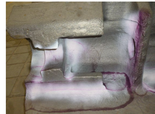
Дефектоскопия гнезда гантели
